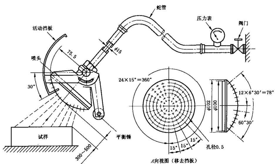
图 5 检验第二位特征数字为 3 和 4, 防淋水和溅水手持式试验装置(喷头)
